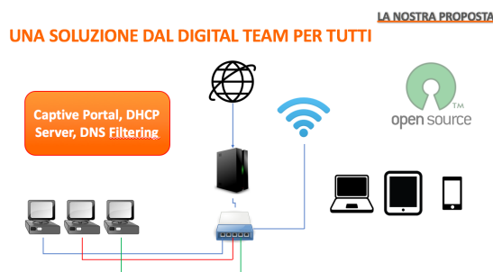
Fig. 1. Architettura della Soluzione tecnologica di Liguria Digitale per il BYOD.
